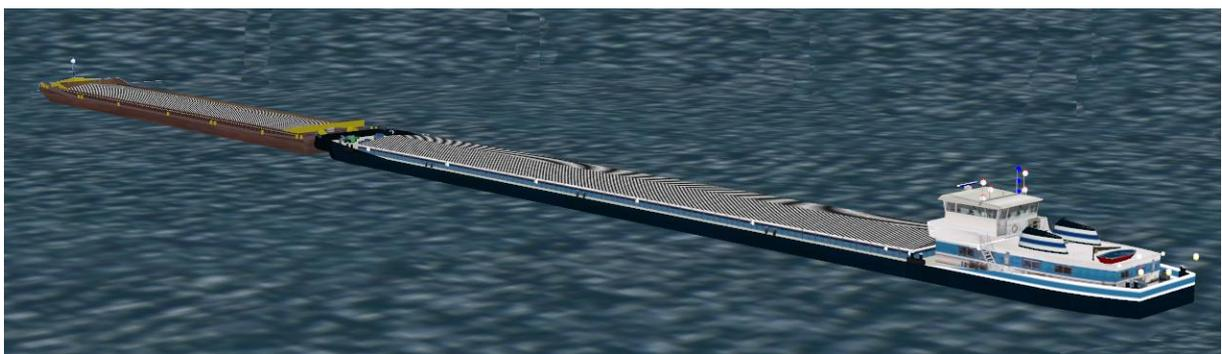
Abb. 3 – Sichtdarstellung des Koppelverbandes (Spargel) für die Bergfahrt
