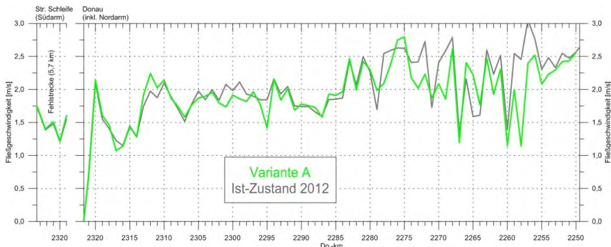
Abbildung: Fließgeschwindigkeitslängsschnitt der Donau bei HQ 100 , tiefengemittelte Fließgeschwindigkeiten jeweils in der Donaumitte an jedem vollen Do.-km
