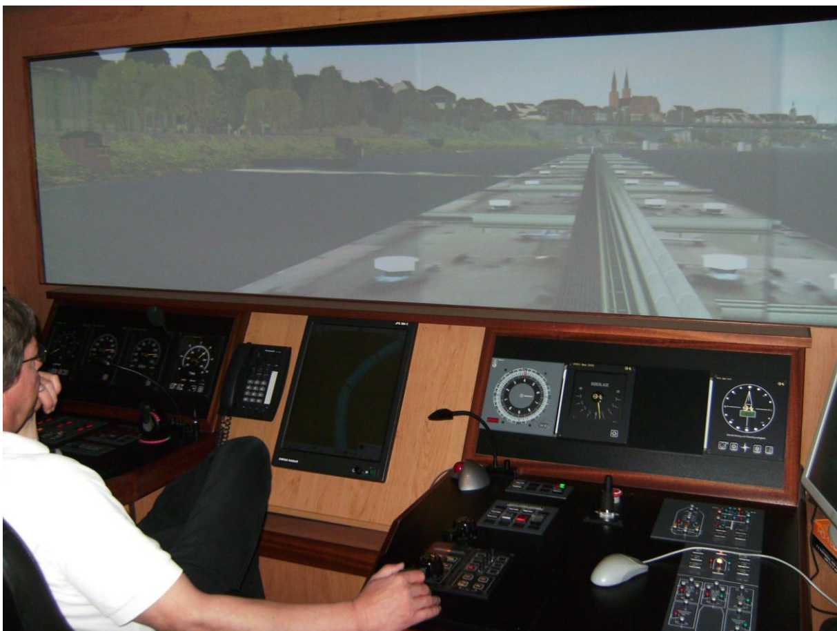
Abb. 29 - Brücke: Ausstattung und 210°-Projektionswand
